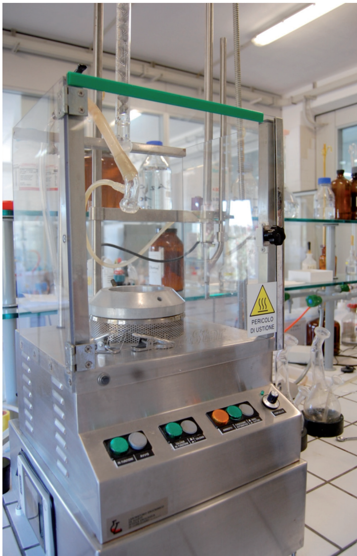
Fig. 9 - Apparatus di distillazione utilizzato per la determinazione dell'acidità volatile. (Foto AGRIS Sardegna)
