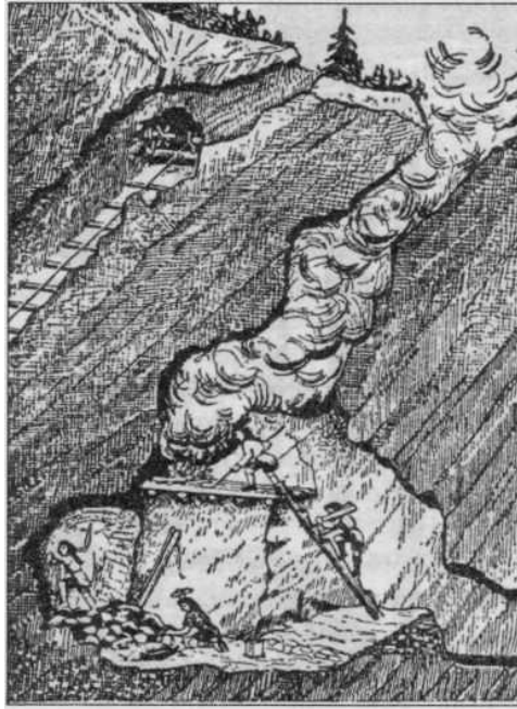
Ricostruzione di una miniera di rame a Mitterberg in Tirolo. Il fuoco veniva usato per riscaldare, cuocere, rendere friabile la roccia e poterla poi frantumare con facilità.
